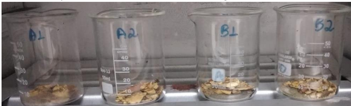
Figura 4 – Determinação do teor de umidade nas amostras A e B em duplicata.
