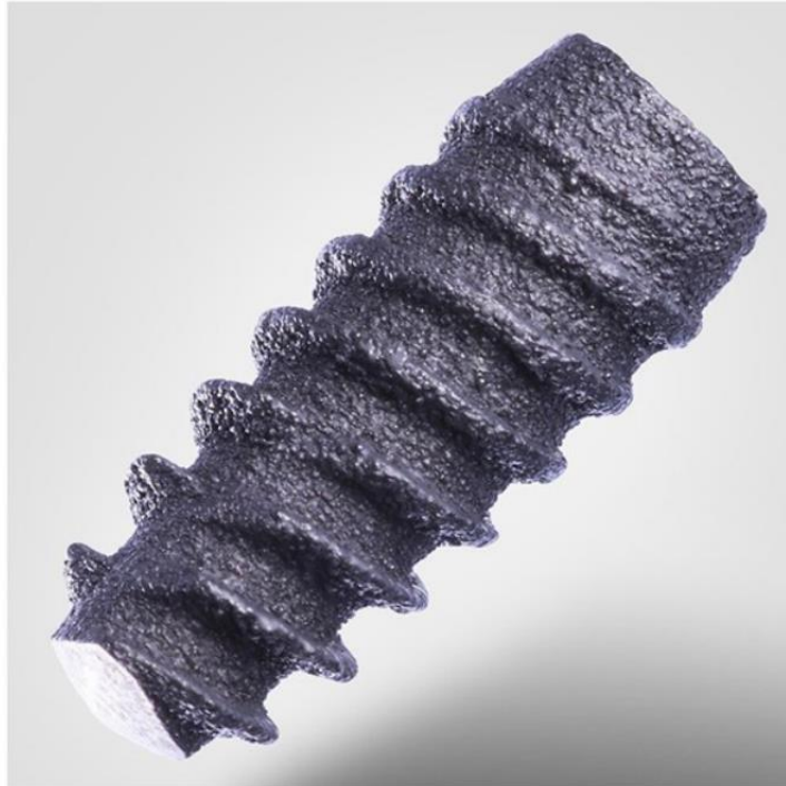
Figura 5 – Rugosidade superficial de implante confeccionado pela tecnologia de impressão em 3D.
