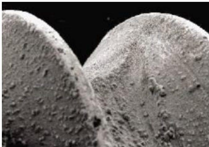
Figura 4 – Superfície de implante com tratamento de superfície físico.
